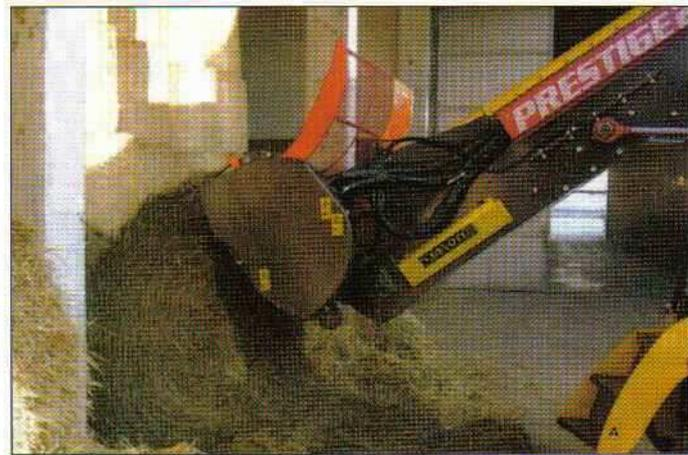
Il braccio fresa autocaricante è ad alto rendimento: un potente motore idraulico permette alla fresa di lavorare tutti i tipi di insilati e di prodotti fibro-
