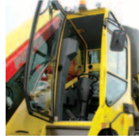
L'entrata anteriore facilita l'ingresso a chiunque. Inoltre da la possibilità all'allevatore di lavorare vicino alle pareti dei silos senza problemi di spostamento e di uscita.
