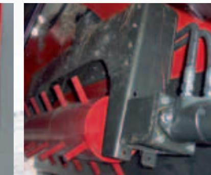
Rullo dosatore sul nastro di scarico - Rouleau de meuleur sur tapis de déchargement
